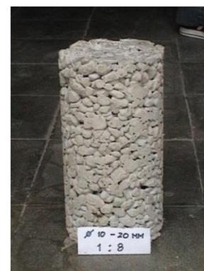
**Gambar 5.** Benda uji silinder
